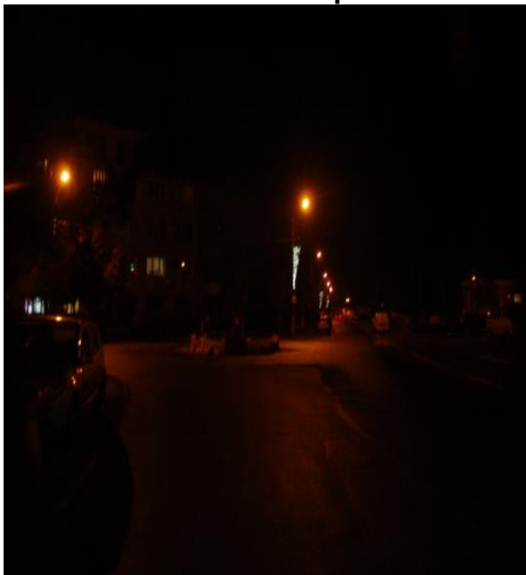
Centru intersectie DJ-clasa M5 Luminanțe insuficiente, cca 0,25 cd/m 2
