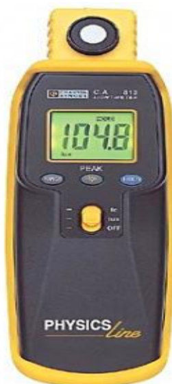
Fig. 3.1. Luxmetrul digital Chauvin Arnoux CA 811
